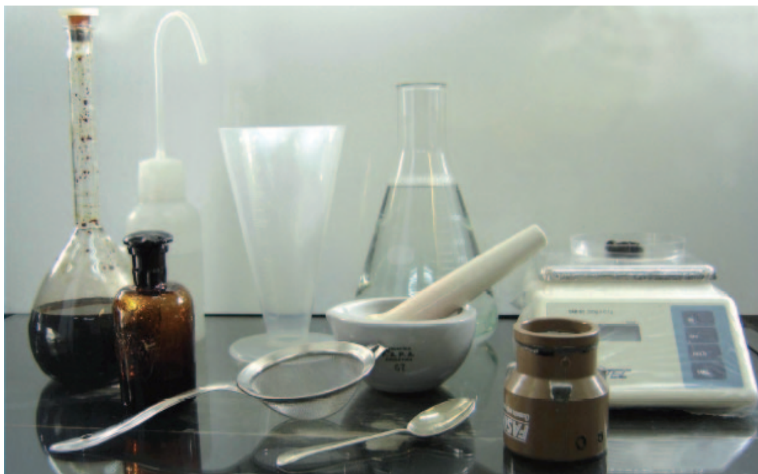
Equipo necesario para la realización de la técnica de sedimentación.
